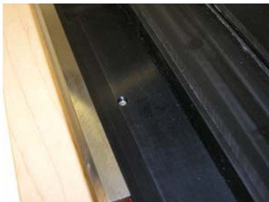
Knife bevel edge shown
